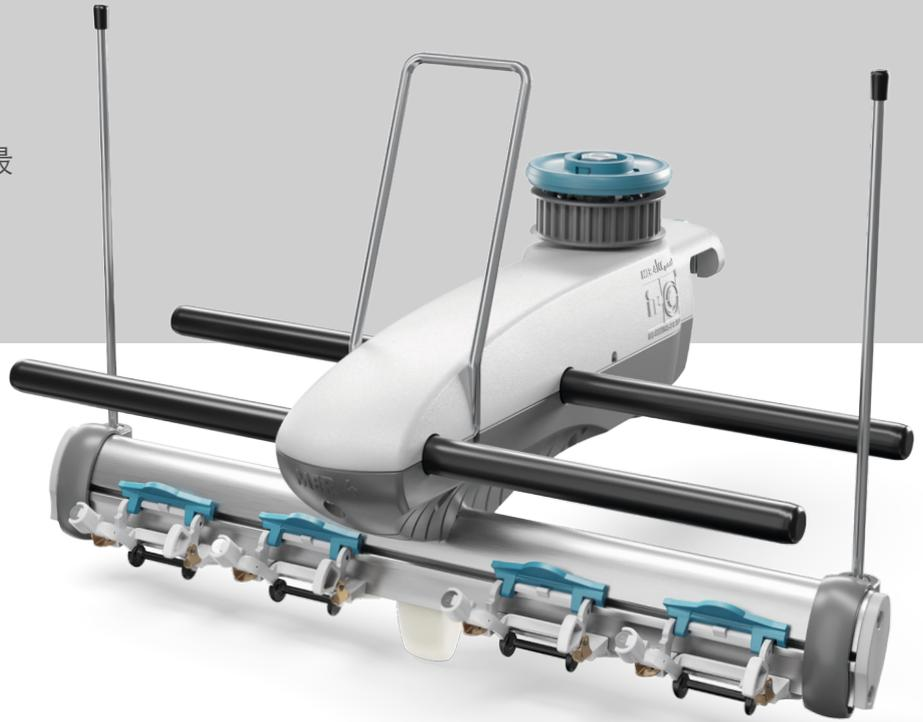
外形精美的MER 4是专为大圆机上输送氨纶裸丝而设计的氨纶送纱器. 在原有的基础上,进一步改进,使其送纱更完美,编织张力更低. 自停器无电气元件,清洁方便
