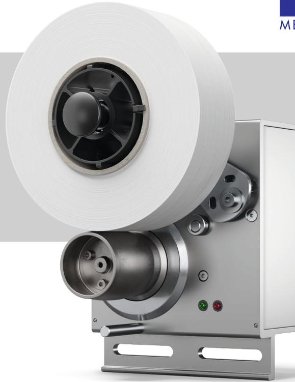
ELAN可在袜机和无缝内衣机上积极送纱。可在低张力情况下喂纱，使布面整洁无瑕疵。
