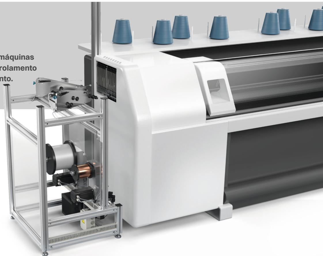
O MTD é um dispositivo positivo para máquinas retas onde o material é desenrolado na direcção radial (tangencial) em vez de axial. Isto permite o desenrolamento sem torção do material a ser processado.
