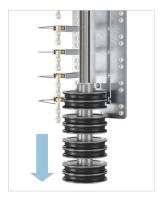
摩擦轮 换摩擦带时MJS 2不需 拆下。
