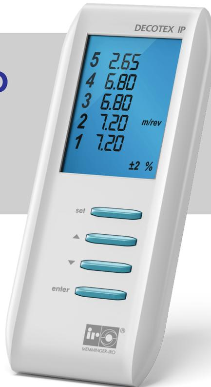
**El DECOTEX IP es un medidor de alimentación de hilado diseñado para la medición continua de consumo de hilado en máquinas circulares de tejido de punto con alimentación positiva. El sistema detiene a la máquina cuando es necesario.**
