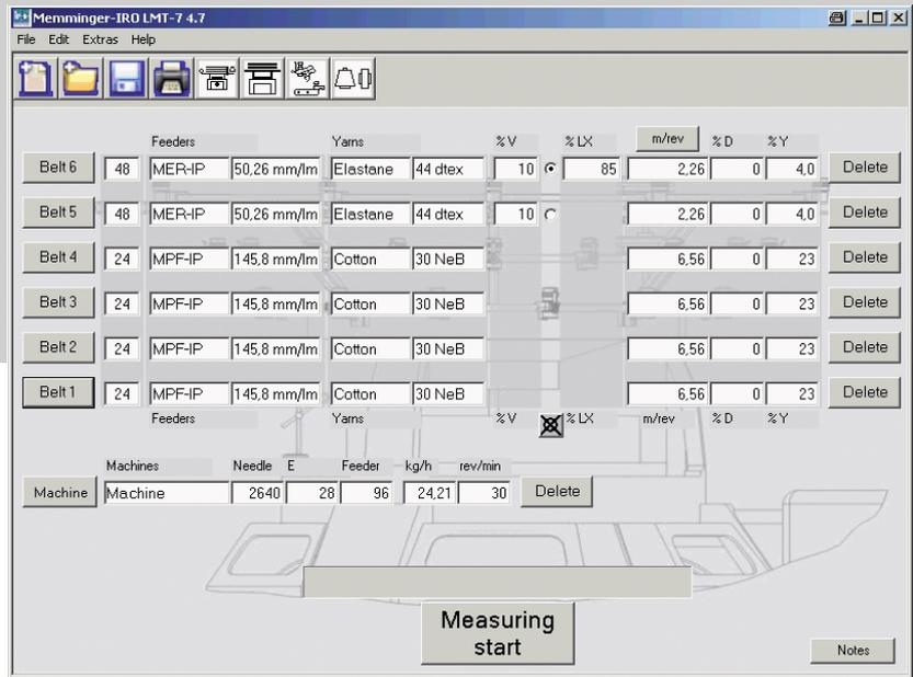
LMT 7 是计算机控制的电子量纱仪。它采集、处理大圆机上积极式送纱器的纱速数据，并可测氨纶的送纱量。
