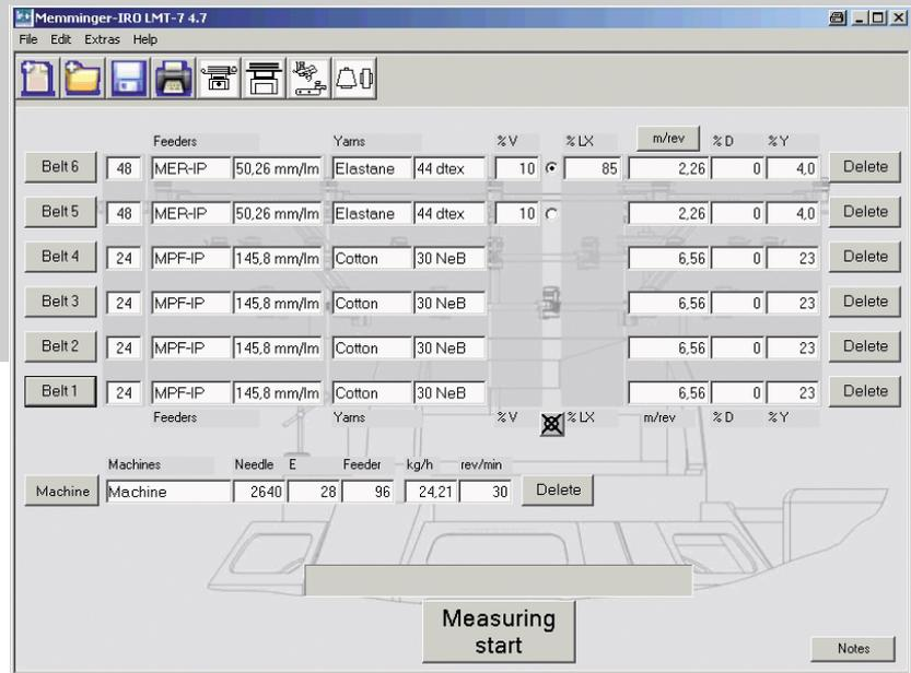
**Le LMT 7 est un appareil de mesure électronique de consommation du fil basé sur un logiciel. Il détecte et contrôle les données de production sur les métiers à tricoter circulaires à consommation continue de fil de base avec et sans fil d'élasthane alimentés en positif.**
