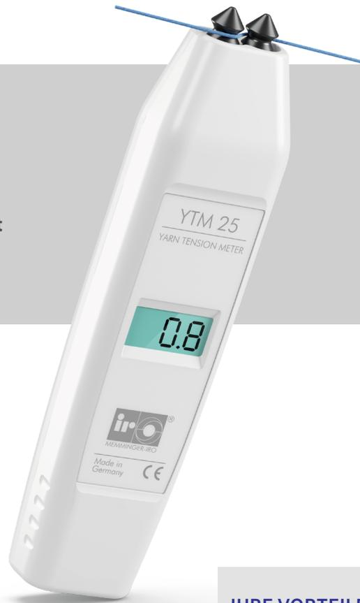
**YTM ist ein digitales Messgerät zur Messung der Fadenspannung an Strickmaschinen.**
