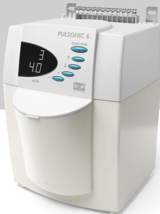
PULSONIC 6 加油机每脉冲将精确的很小的油量送到需要润滑处。每个润滑点可编程调整。大幅降低下降。布面保持干燥，大大减少油斑。PULSONIC 6 可接12 或24 喷嘴。油量由简单按钮设定。如果织机的面板已内置CAN总线通讯功能并且主机厂已配置好与加油机的通讯连接，则可以直接在面板上设置PULSONIC 6 润滑系统。
