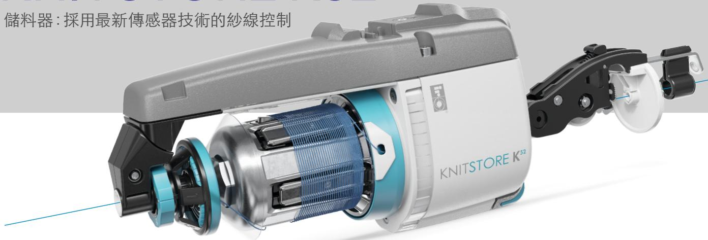
KNITSTORE K52採用固定式繞紗鼓設計，分紗穩定，可應用於規則或不規則用紗量的各類針織設備，57 V直流供電，內置CAN BUS通訊功能。紗線的捲繞方向可根據所用紗線的捻向要求（S捻或Z捻）進行調整，全新開發的光學-機械混合式傳感器系統精確控制儲紗量。
