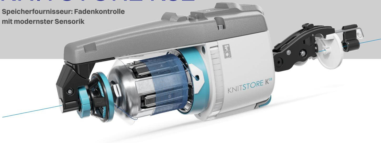
**Der Speicherfournisseur KNITSTORE K52 mit stehendem Wickelkörper und Fadenseparation dient der Fadenzuführung an Strickmaschinen mit regelmäßigem und unregelmäßigem Fadenverbrauch.**
