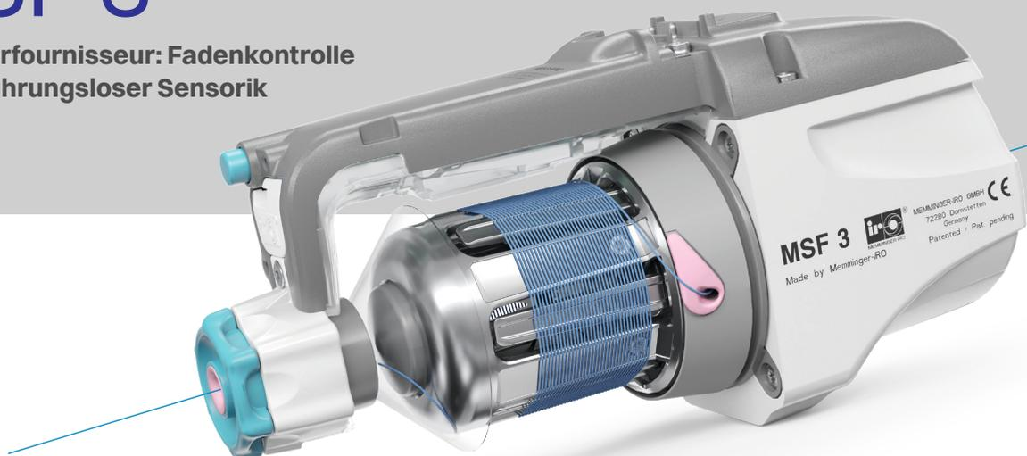
**Der Speicherfournisseur MSF 3 mit stehendem Wickelkörper dient der Fadenzuführung an Strick- und Wirkmaschinen mit regelmässigem und unregelmässigem Fadenverbrauch.**
