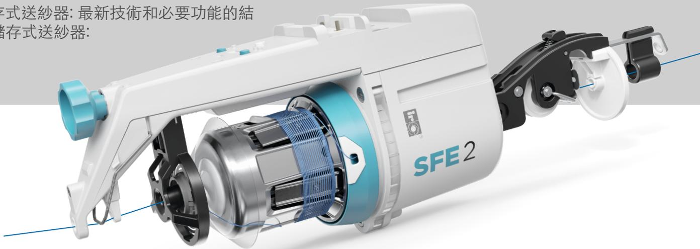
SFE 2 儲存式送紗器專為具有可變的紗線喂入需求的針織機所設計。該裝置在 3 x 42 VAC 下運行。
