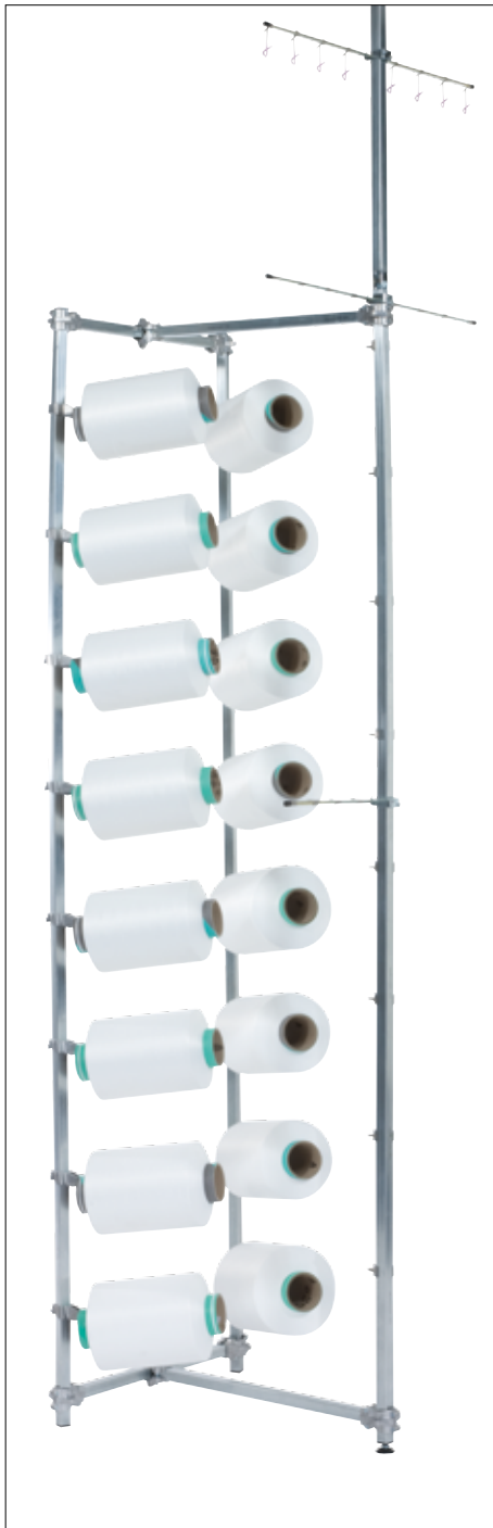
Offene Fadenführung mit Reservespule
